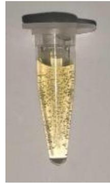
左图显示,二氧化锰纳米颗粒使 TMB 显色;右图显示,二氧化锰纳米颗粒使 H<sub>2</sub>O<sub>2</sub> 快速释放氧气。
